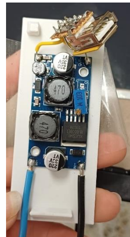
Ilustración 1-4 Conexión cableado convertidor DC-DC
